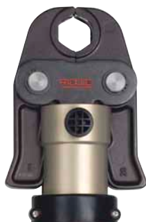
Стандартные пресс-клещи для V-систем
