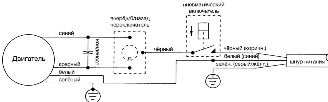
Схема подключения двигателя
