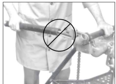
**Не используйте** – ключ с повернутой или изогнутой ручкой. Изогнутая ручка свидетельствует о перегрузке ключа и может сломаться. Изогнутую ручку нельзя выпрямлять. Ключ с изогнутой или повернутой ручкой следует убрать из обращения.
