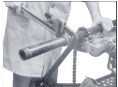
При использовании ключа RapidGrip, расположите деталь по центру в “V” верхней щеки. Если деталь не соприкасается с обеими сторонами “V”, это может ослабить захватывающее действие ключа и произойдет поломка щеки.
