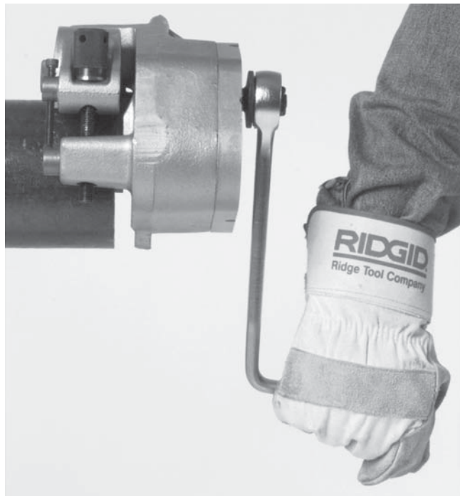
Рисунок 6 – Накатка желобков на трубу
