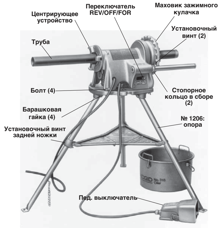
Рисунок 3 – Силовой привод № 300, установленный на опору № 1206 со смазчиком № 418
