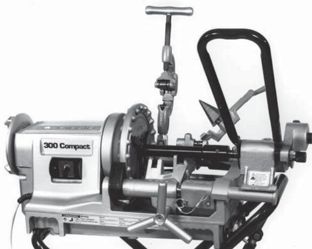
Рисунок 20 – Желобонакатчик №916 и переходник установлены на станок №300
