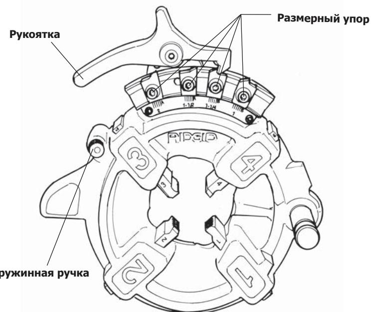
**Рисунок 13 – Полуавтоматическая головка**
