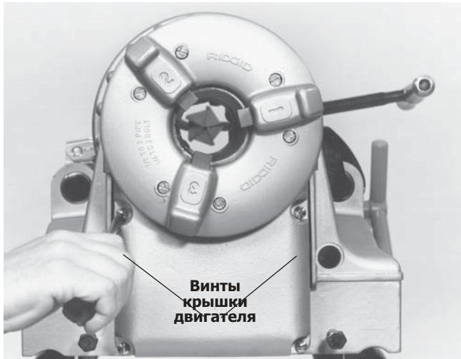
**Рисунок 28 – Ослабьте и вытащите винты крышки двигателя**
