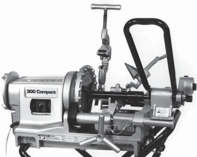
**Рисунок 20 – Желобонакатчик №916 и переходник установлены на станок №300**
