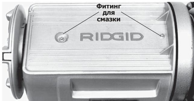
Рисунок 26 – Смазывание подшипников
