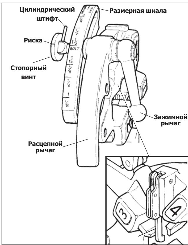
**Рисунок 12 – Универсальная самооткрывающаяся головка**
