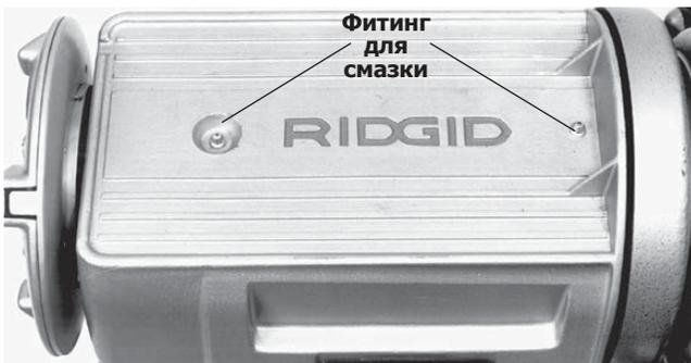
**Рисунок 26 – Смазывание подшипников**
