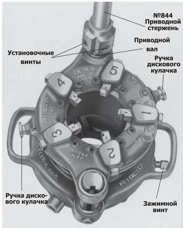
**Рисунок 21 – Головка №141 с установленным приводным стержнем №844**
