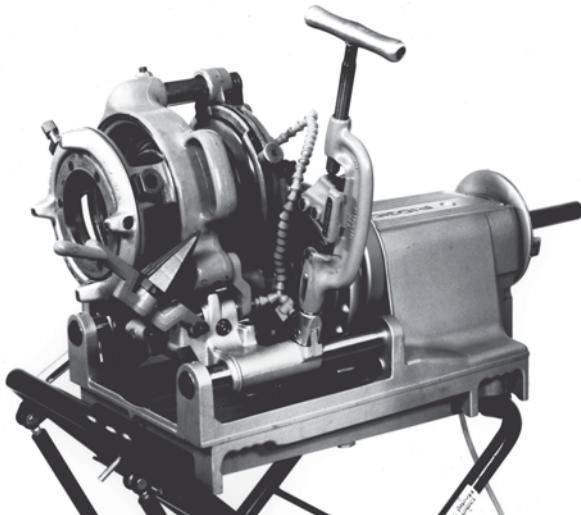
Рисунок 25 – Головка №141 установлена на станок №300 Compact
