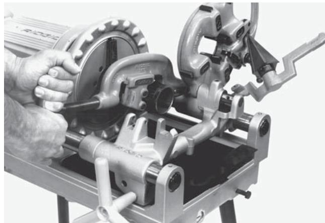
**Рисунок 7 – Обрезка трубы с помощью станка 300 compact**
