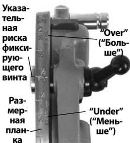
Рис. 13 – Настройка размера резьбы
