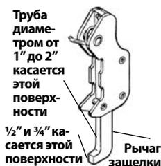
Рис. 14 – Регулировка положения защелки
