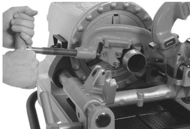
Рис. 22 – Резка трубы с помощью трубореза
