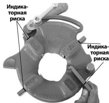
Рис. 8 – Вставка резьбонарезных гребенок
