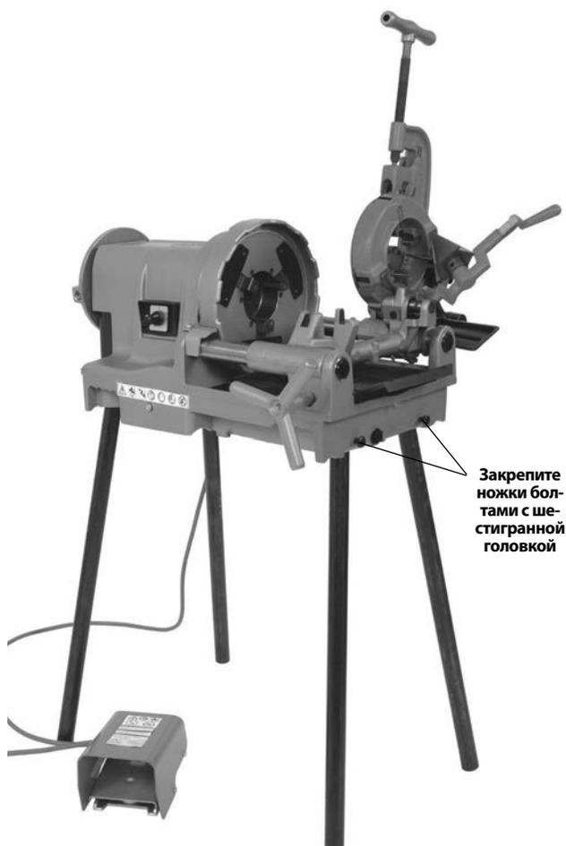
Рис. 4 – Установка резьбонарезного станка на трубные стойки
