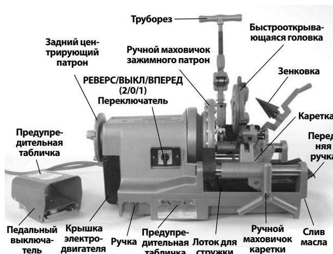
Рис. 1 – Резьбонарезной станок модели 300 Compact
