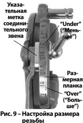
Рис. 9 – Настройка размера резьбы
