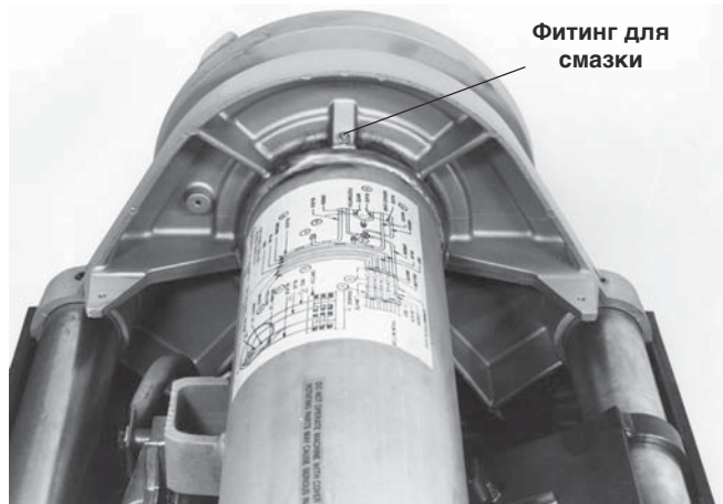
Рисунок 31 – Смазывание подшипников главного вала
