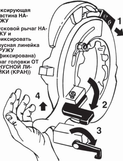
Рисунок 12 – Настройка самооткрывающихся головок № 714 или 914 на резьбы NPSM или BSPP
