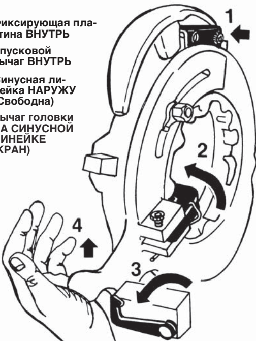
Рисунок 11 – Настройка самооткрывающихся головок № 714 или 914 на резьбы NPT или BSPT
