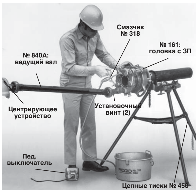
Рисунок 27 – Нарезание резьбы с помощью универсального ведущего вала № 840А и головки с ЗП № 161
