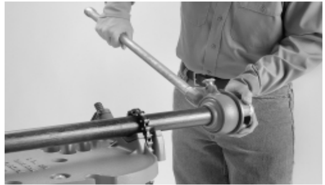
Рис. 3 –Установка инструмента на трубе.
