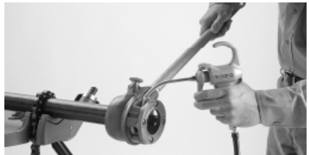
Рис. 4 – Нанесение резьбонарезного масла на трубу
