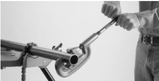
Рис. 1 – Резка края трубы
