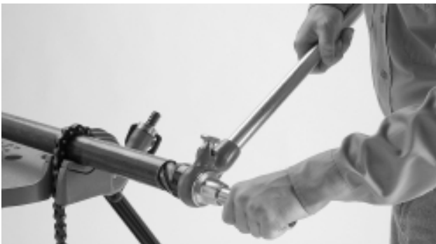
Рис. 2 – Зенкование края трубы.
