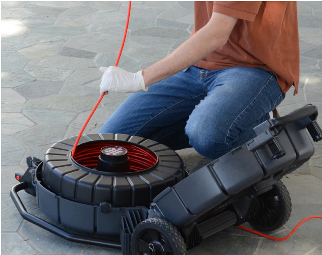
Рисунок 27 – Как направлять проталкивающий кабель в барабан
