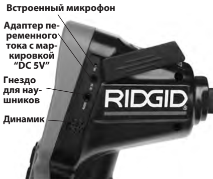
Рис. 3 – Крышка гнезд с правой стороны прибора
