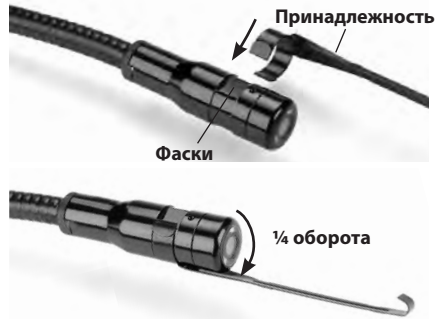
Рис. 8 – Установка приспособления
