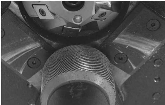
Рис. 16 – Чистые насечки ведущего ролика
