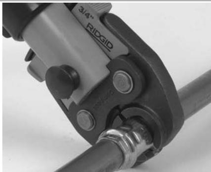
**Рис. 7 – Установка пресс-клещей ножничного типа вокруг фитинга**
