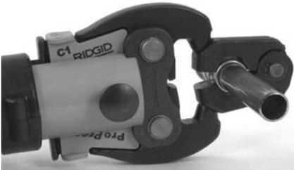
Рис. 10 – Крепление рабочей насадки на обжимном кольце
