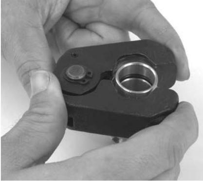
Рис. 9 – Установка обжимного кольца на фитинг
