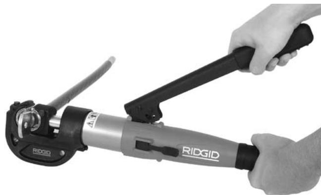
**Рисунок 7 – Работа с обжимным прессом**
