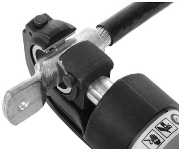
**Рисунок 6 – Выравнивание соединителя**
