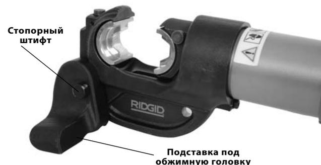
**Рисунок 5 – Установка обжимной головки на подставку**
