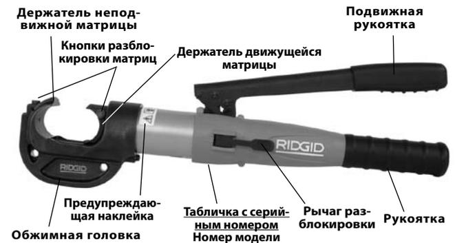
Рисунок 1 – Ручной гидравлический обжимной пресс RE 130-M/RE 12-M
