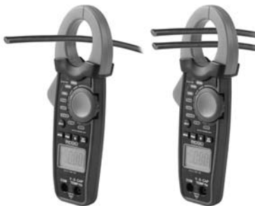
Правильное измерение силы тока Неправильное измерение силы тока Рисунок 8 – Как правильно измерять силу тока
