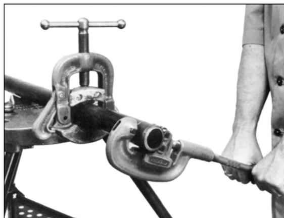
**Внимание** Не вдавливайте режущий ролик в трубу. Это может повредить режущий ролик и сократить его срок службы.
