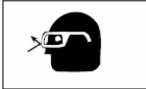
Всегда используйте защитные очки. Будьте осторожны когда прочищаете трубопроводы где ранее использовались химические средства. Остерегайтесь попадания химических средств на кожу и в глаза.
